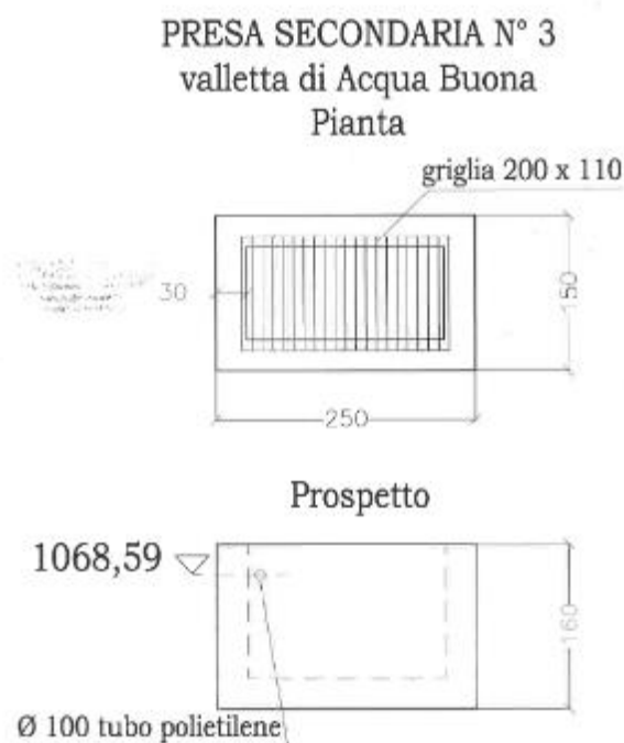
Figura 11: schema manufatto opera di presa
