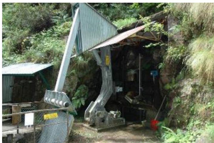
Figura 45: macchinario sgrigliatore in dotazione all'opera di presa
