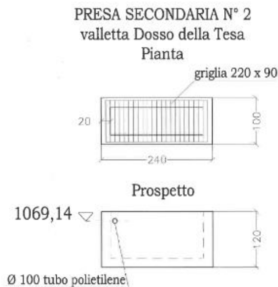
Figura 10: schema manufatto opera di presa
