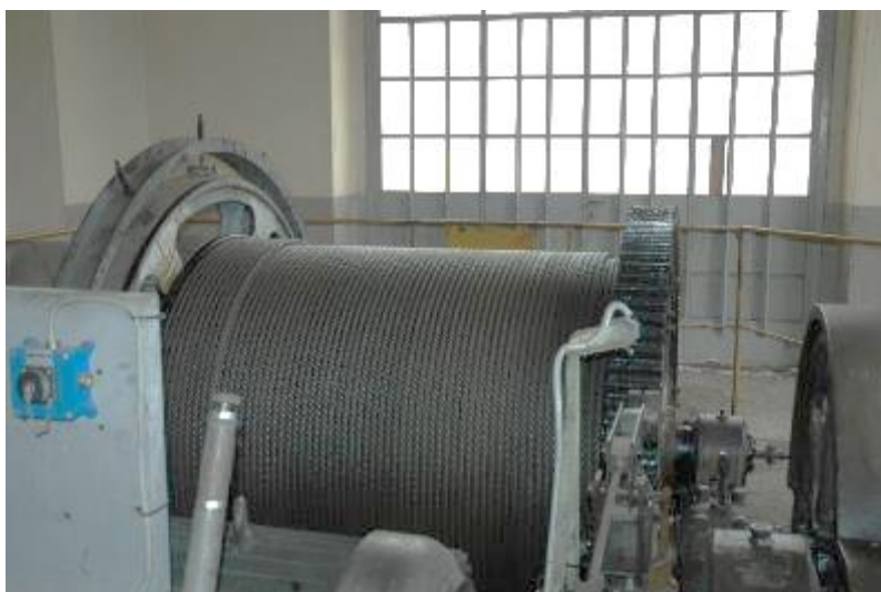
Figura 100: argano elettrico trainante del piano inclinato
