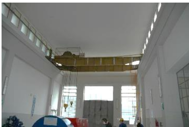
Figura 117: sala macchine vista del carro ponte
