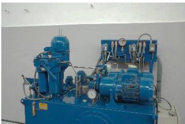
Figura 120: centralina oleodinamica collegata al gruppo di produzione
